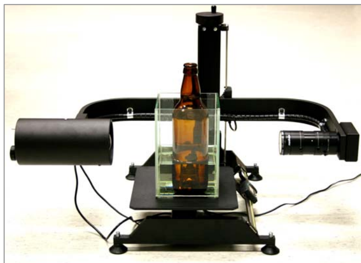
Joonis 4. Automaatpolariskoop AP-07. Immersiooni- vannis on moodetav pudel.
