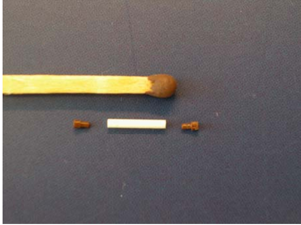
Joonis 3. 1 millimeetrise läbimõõdu- ga tsirkoonoksiidist rootor.
