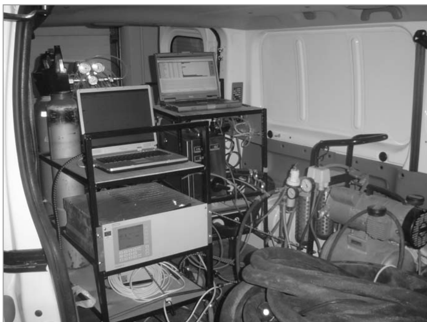
Foto 7. Mobiilne õhuheitmete labor: TOC analüsaator FIDAMAT 6 ja FTIR spektromeeter GASMET DX 4000.
