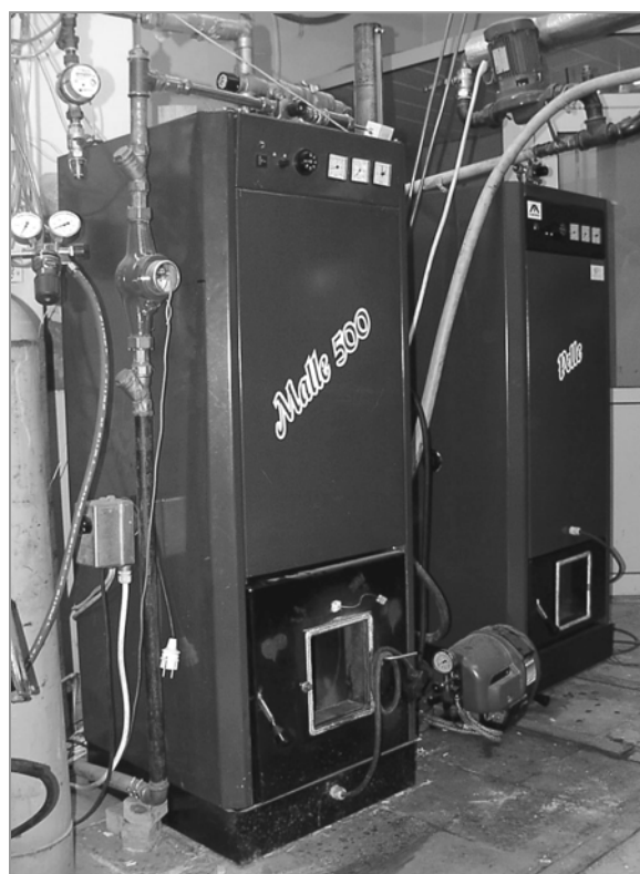
Foto 6. Kodumaised biokütuse katlad soojustehnika instituudi põletusseadmete katselaboris.
