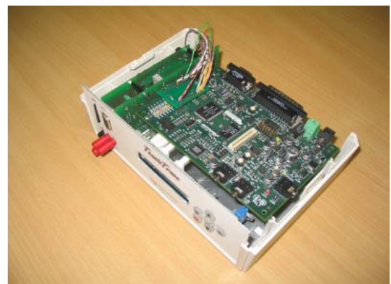
Foto 1. TensioTrace – seade vererõhu pidevaks mitte-invasiivseks jälgimiseks.
