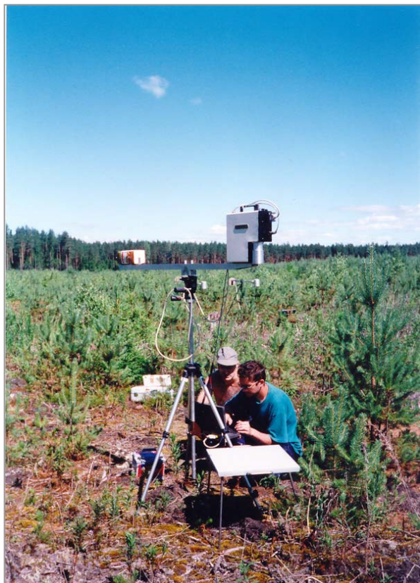
Välimõõtmised spektromeetriga (GER-2600) metsanoorendikul Kongutas. Pildil vanemteadur A. Kuusk ja doktorand M. Lang spektromeetrit kalibreerimas.
