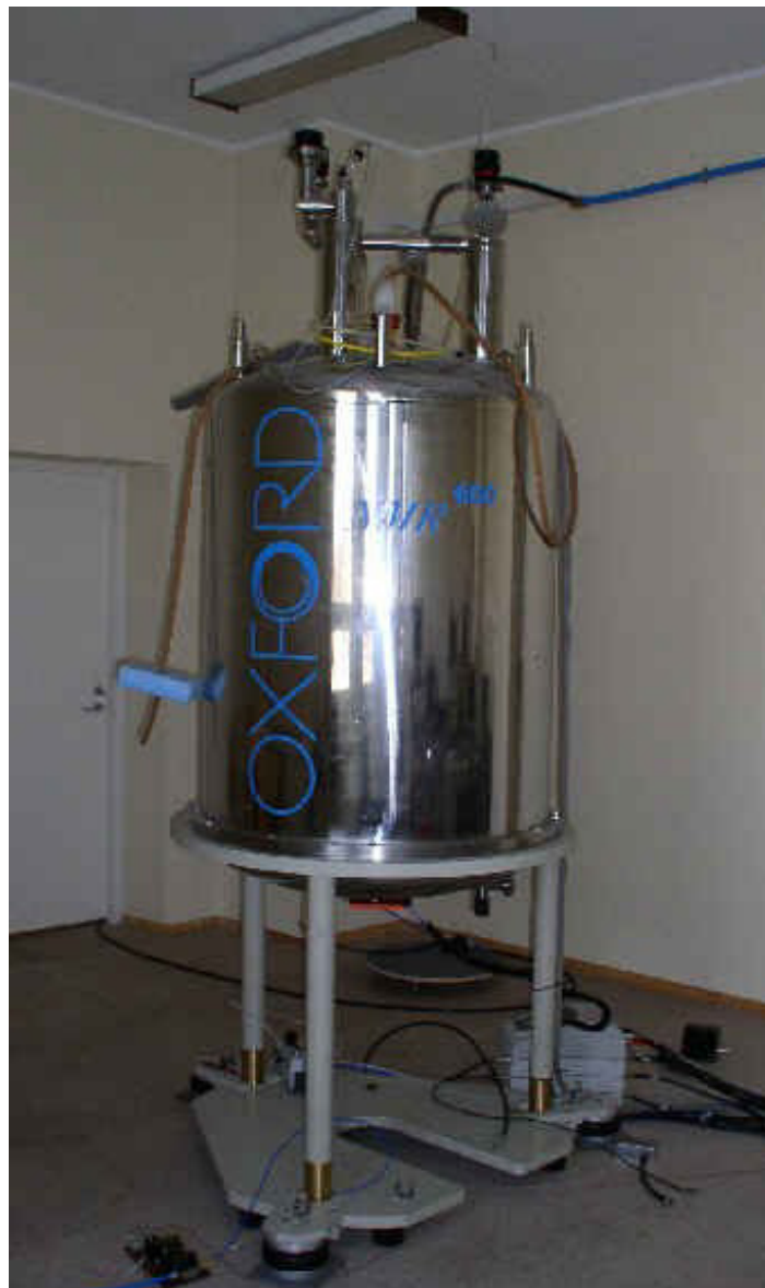
600 MHz-spektromeetri uus Oxford Instruments'i ülijuhtmagnet.
