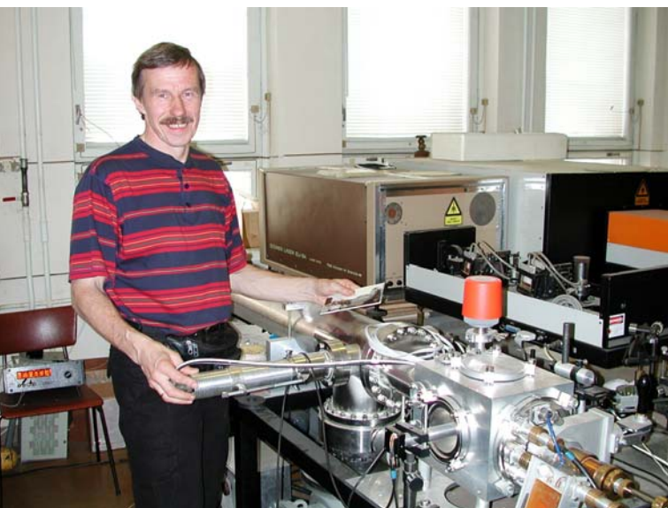
J. Subbi koos täielikult KBFi-s konstrueeritud ja valmistatud MALDI-TOF massispektromeetritega.
