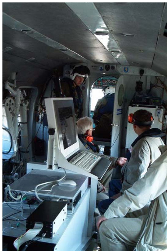
LDI lidar monitoorimas merd läbi lennukipõranda.
