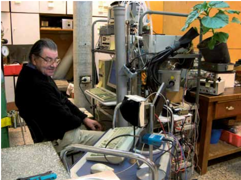
Joonis 10. Vello Oja oma kuningriiki valitsemas. Rahvusvahelise fotosünteesiuurijate teadusliku ühingu innovatsioonipreemiaga autasustatud aparatuur, mis mõõdab CO 2 , O 2 ja veeauru voogusid, klorofüllü fluorestsentsi ja lehe spektri väikesi muutusi.
