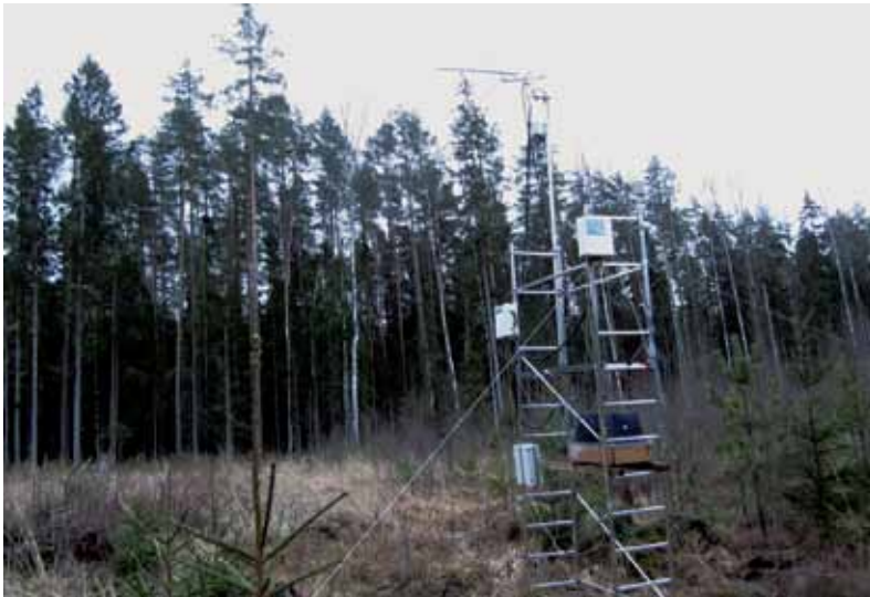
Joonis 3. Süsinikuvoogu mõõtmine turbulentsse kovariatsiooni meetodil: installeeritud seadmed Järveljal.
